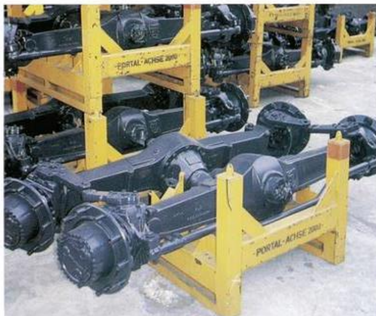
Conteneur pour stockage d'essieux de poids lourds, manutention par convoyeur à rouleaux.
