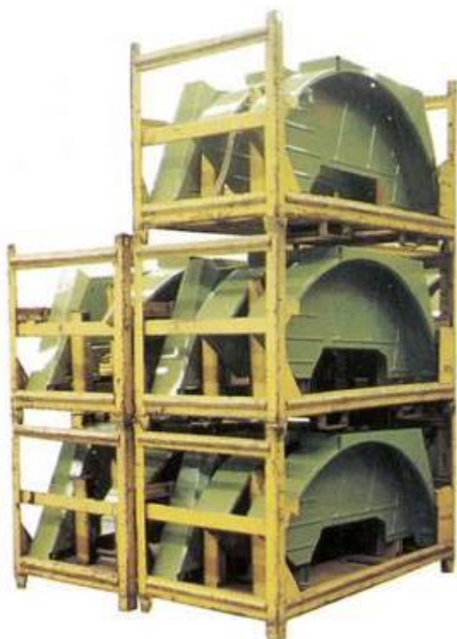
Conteneur pour stockage de grandes pièces semi-circulaires en inter-opération.
