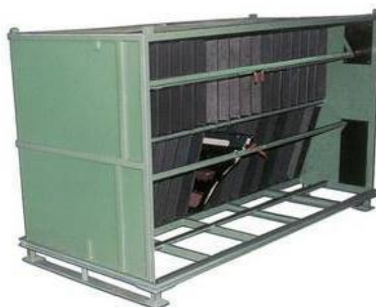
Conteneur spécifique pour stockage et transport de pièces d'aspects, garnitures de portes stockées dans des alvéoles en polypropylène.
