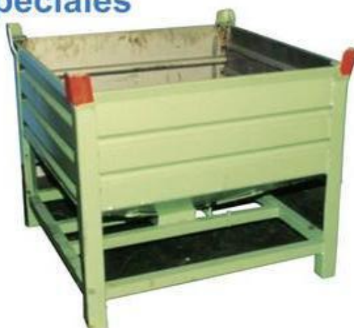
Conteneur trémie avec système. d'extraction en partie basse. registre à tiroir. Extraction possible par vannes papillons, registres à casques, etc.. Peut se concevoir avec la partie haute complètement fermée + orifice de remplissage avec couvercle.
