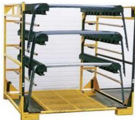
Conteneur spécifique pour stockage de pièces de structures automobile.
