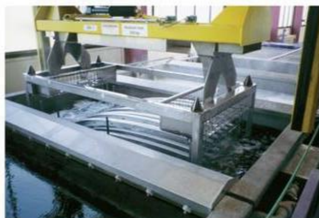
Stand-rack spécifique pour manutention et stockage de produits flexibles recevant un traitement de surface par immersion.
