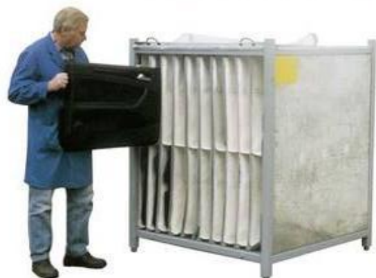
Conteneur dit «Mutibag» Garnitures de portes ou tablettes arrières stockées en alvéoles textiles interchangeables. Fermeture par bâche polypro, côté chargement.
