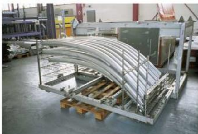
Stand-rack spécifique pour manutention et stockage de produits flexibles recevant un traitement de surface par immersion.
