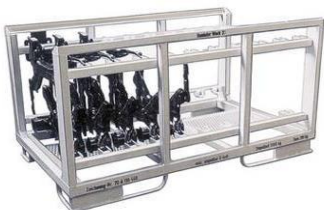
Conteneur spécifique pour stockage et transport de pièces de structure de châssis automobiles.
