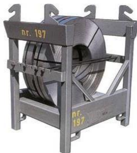
Rack support élingable pour stockage et transport de bobines de feuillards. Manutention par palonnier, au pont roulant.
