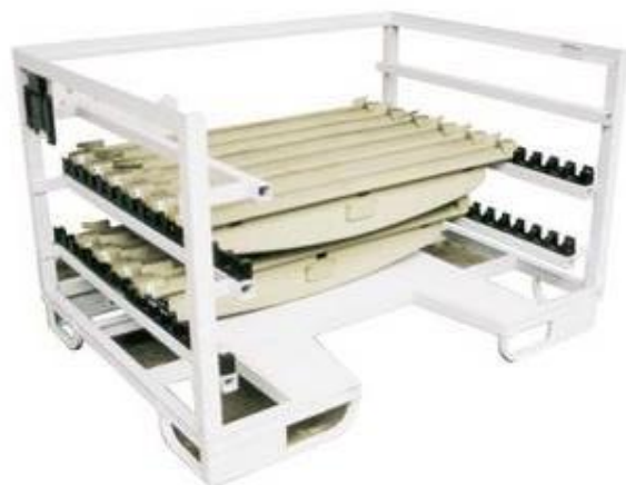
Conteneur spécifique pour stockage de longerons dans l'industrie automobile.
