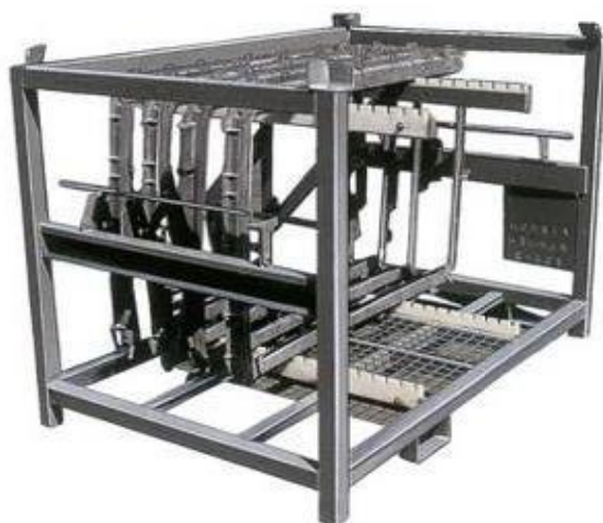
Conteneur rack spécial pour stockage d'ossatures de toits ouvrants de l'industrie automobile.
